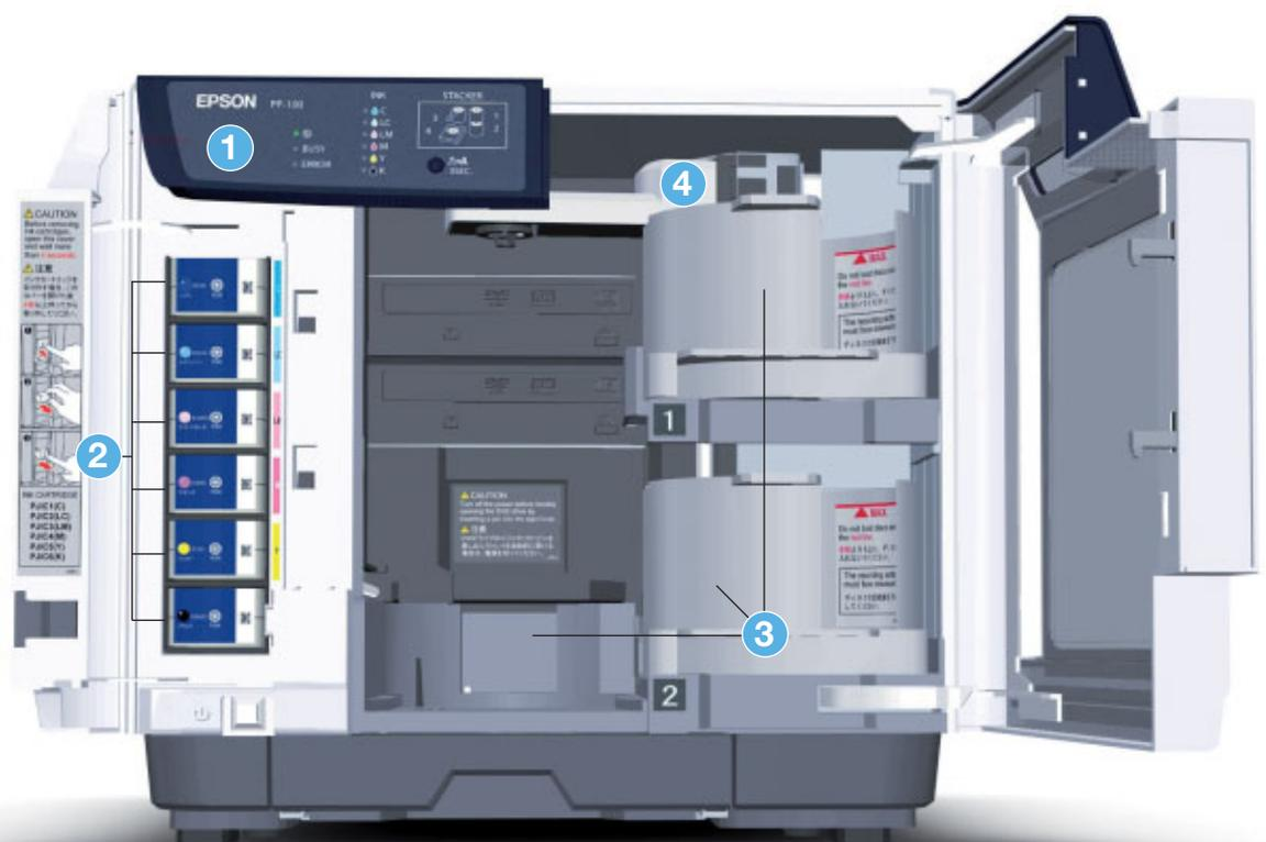
O Epson Discproducer™ é o único Discproducer que indica o nível de enchimento dos cartuchos de tinta através de LED para cada cor e que assim o protege contra a "impressão sem tinta".
