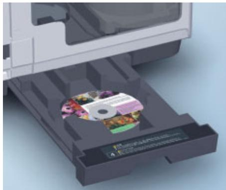
El práctico cajón facilita la extracción de medios individuales. Aquí se depositan los medios que no pueden leerse, si los hubiera.
